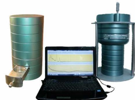
**Уникальная технология:** позволяет одновременно определять качественный и количественный состав широкого спектра бета и гамма - излучающих радионуклидов **в нативной пробе.**
