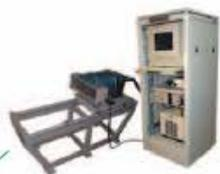
Спектрометрический комплекс для непрерывного контроля теплоносителя 1-го контура реактора «СТПК-01»
