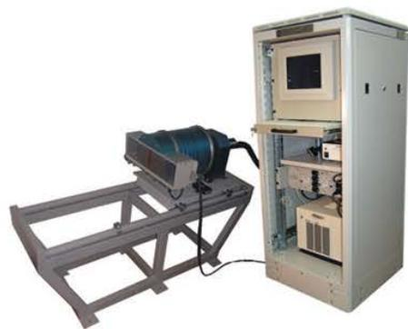
Спектрометрический комплекс контроля активности теплоносителя первого контура **СТПК-01**
